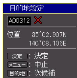
カーソル付近に複数のマークがある場合、【目的地】を繰り返し押して候補を切り替え、目的地にするマークを表示します。
