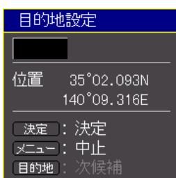
3. ジョイスティックを操作して、目的地にするマークにカーソルを合わせます。
